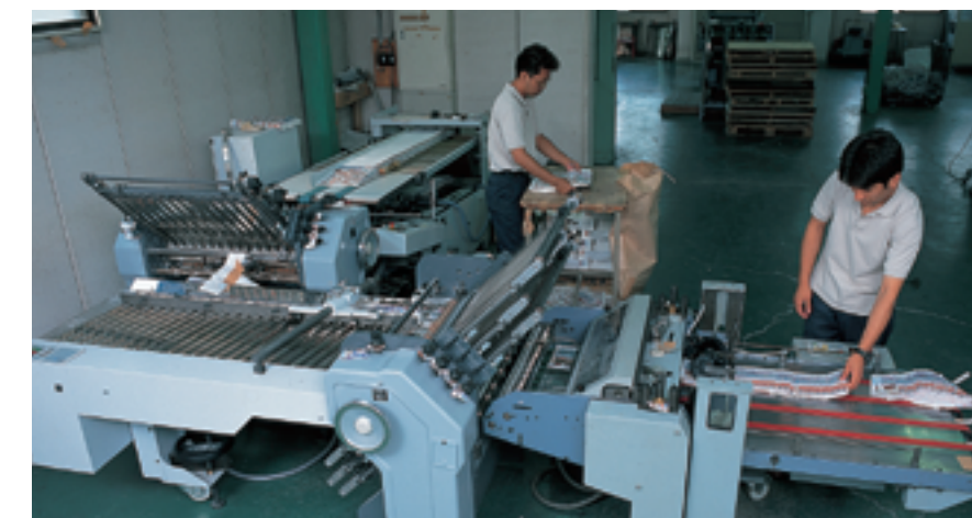
今年導入されたTD66を含め、同社のスタールにはすべてラウンドフィーダ、ストリームシングルプレスデリバリが装備されている
