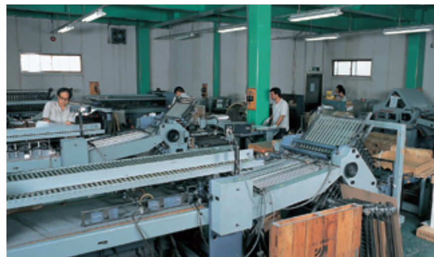
その信頼性の高さはもちろん、複数機を仕事により組み合わせて効率的な作業を行う目的で、折り機はスタールに統一されている
